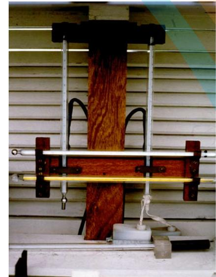
Dry-bulb, wet-bulb thermometer
